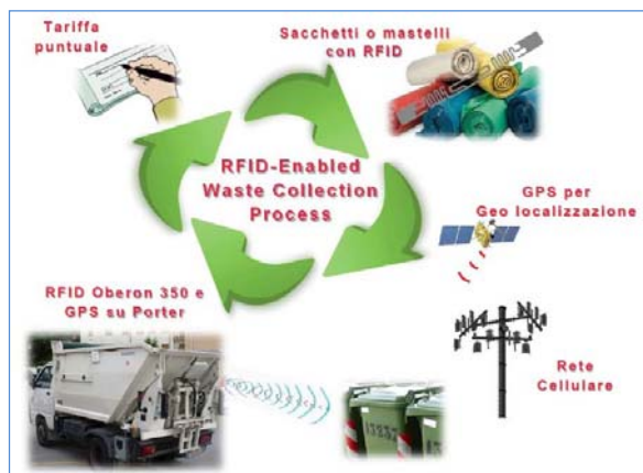
Figura 28 Sistema di Tracciabilità del Rifiuto con Tecnologia RFID
