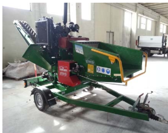
Figure 43/44 Autocarro e biotrituratore in dotazione ATO Rg1 per campagne di compostaggio
