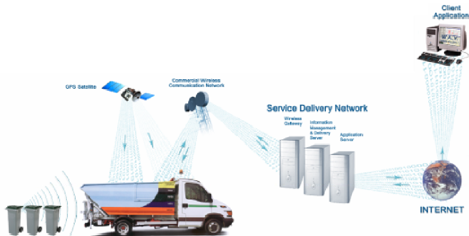
Figura 55 Sistema di controllo tramite GPS
